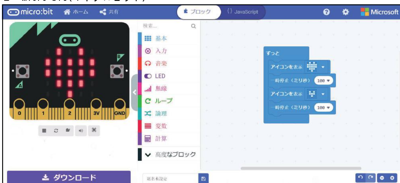
図2 <ハート形にLEDを点滅させるプログラミングの例>
